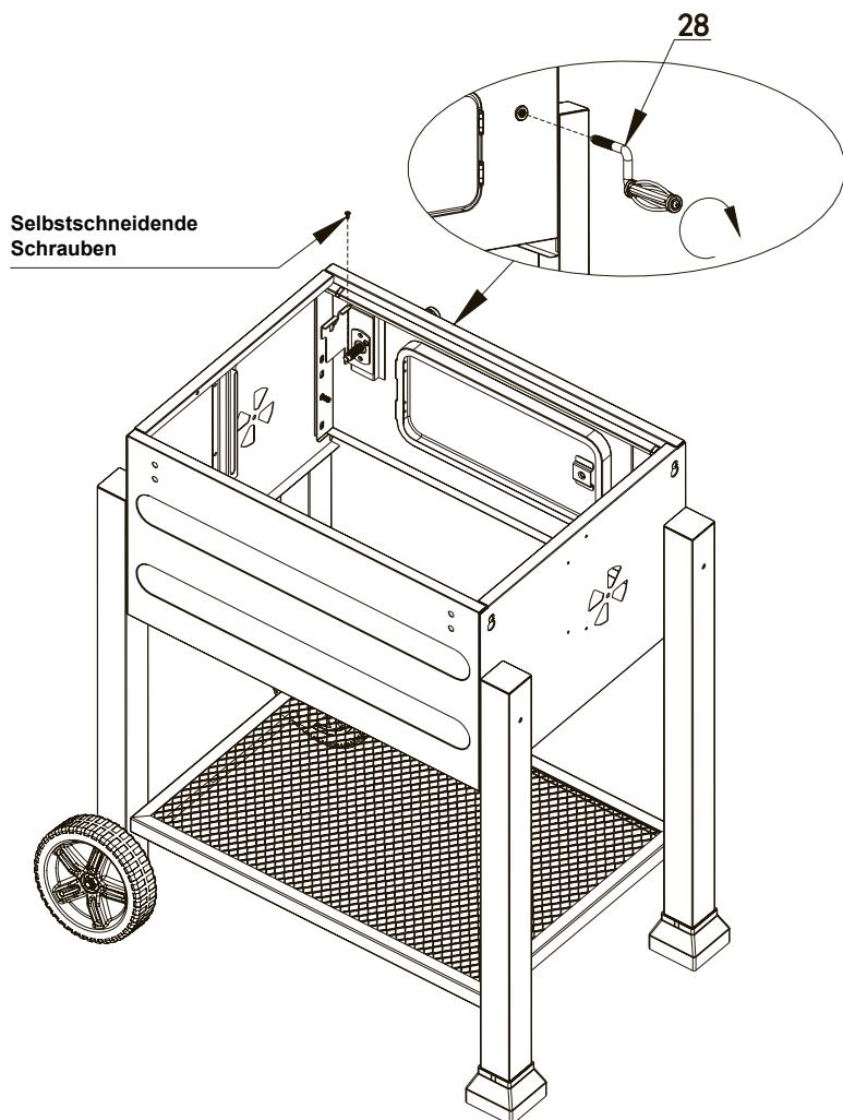
Bemerkung: Achten Sie darauf, dass sich die Kurbel bis zum Ende gegen den Uhrzeigersinn drehen lässt.
