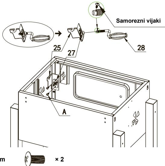
Odvijte predmontirani samorezni vijak iz konice kljuke in snemite kljuko z nosilca.
